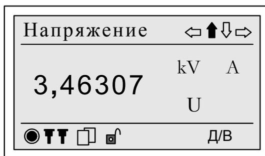
Рисунок 27 – Пример отображения на дисплее счетчика характеристик напряжения
