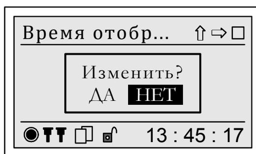
Рисунок 95 – Запрос на подтверждение изменения параметра работы дисплея
