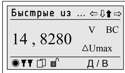
Рисунок 18 – Пример отображения на дисплее счетчика результата регистрации БИН
